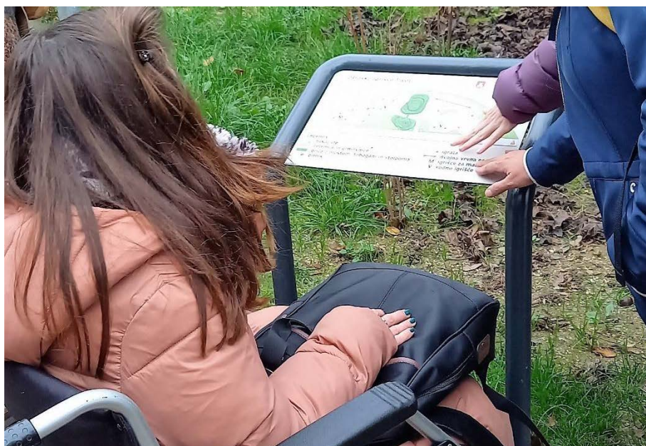
Slika: Taktilna tabla z napisi v Braillovi pisavi umeščena na višini primerni za obiskovalce na invalidskem vozičku (foto arhiv projekta).
