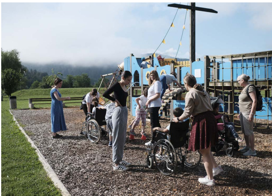
Slika: Dvignjen robnik in varovalna podlaga iz lesnih sekancev otežujta dostop do igrala z invalidskim vozičkom (foto arhiv projekta).
